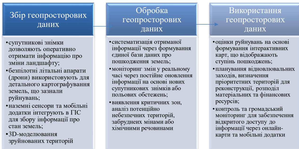
Рис. 3. Основні етапи процесу використання геоінформаційних систем для післявоєнного відновлення земель сільськогосподарського призначення
